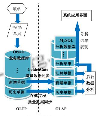
图 2 系统数据处理流程
