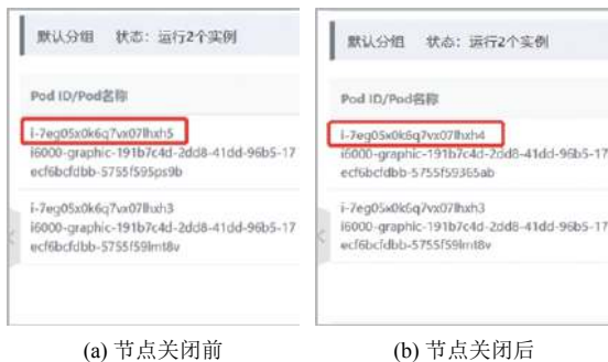
图10 实例漂移测试(方框中为节点ID)
