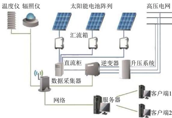
图1 分布式光伏发电系统
