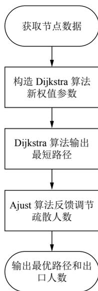
图1 改进 Dijkstra 算法路径规划流程图
