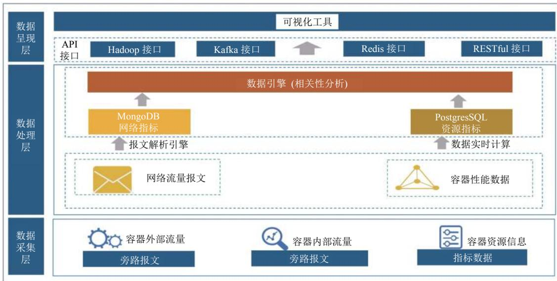
图7 容器立体化监控系统总体架构图
