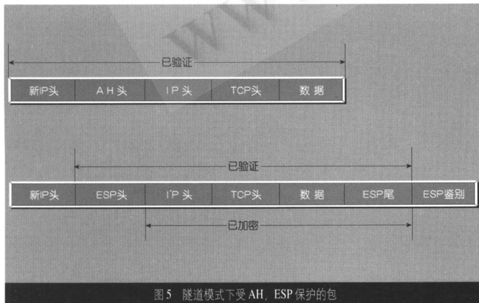
图 5 隧道模式下受 AH、ESP 保护的包
