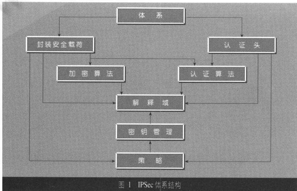
图 1 IPSec 体系结构
