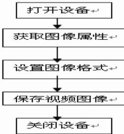
图 4 图像采集流程图
