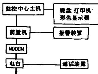
(2)下位机。下位机包括信号采集装置、信号调理装置、A/D转换、微机、调制解调器、电台等组成。
