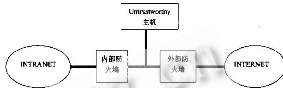
在每一种结构中,防火墙位于网络的边界用于访问控制,主要为了保护内部网络与不可靠网络的连接。完全位于网络内部的防火墙也可以提供网络上不同子网间的相互保护。内部不同子网间的访问控制与内部网和 INTERNET 之间的访问控制没有区别,所以所有的上述结构也可以用于内部网络的防火墙。
