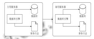
图 3 内存数据库的热备份体系结构
