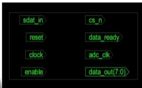
图 6 TLC549 顶层模块图
