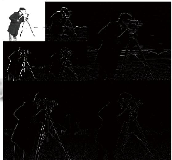
图 2 图像二层小波分解图
