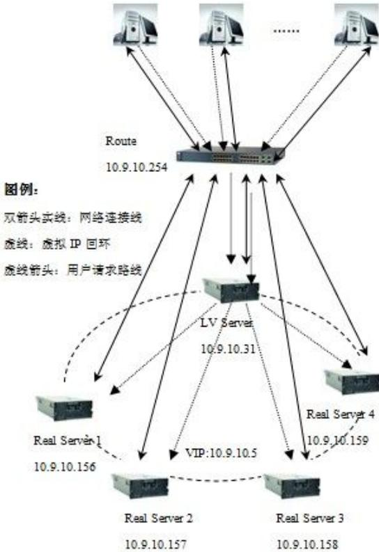
图 1 系统 LVS 负载均衡架构
