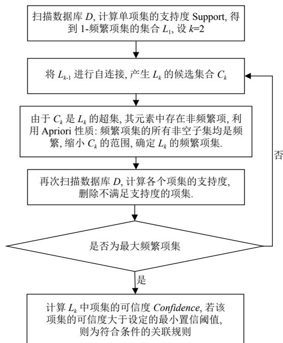
图3 算法流程图
