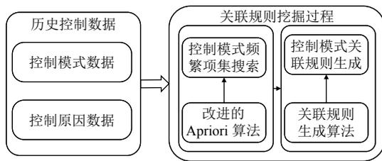
图4 关联规则挖掘概念模型
