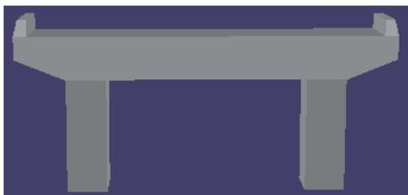
图 20 盖梁柱式墩模型
