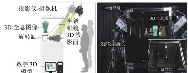
图 1 系统原理图及其原型系统
