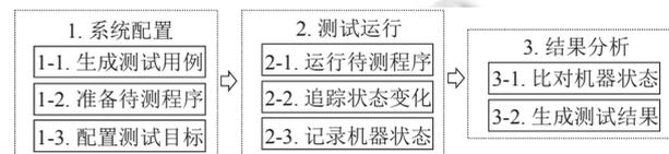
图 2 语义等价性测试系统整体流程图
