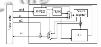
图 3 PEC-V 的电路逻辑图
