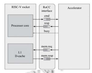
图 2 RoCC 接口架构细节
